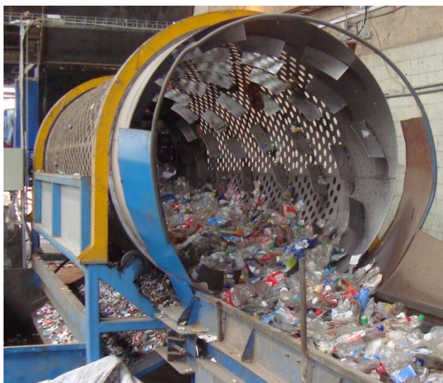
Удаление посторонних включений перед сортировкой отходов ПЭТ-тары/ Фото: ИП «РеПлас-М»
