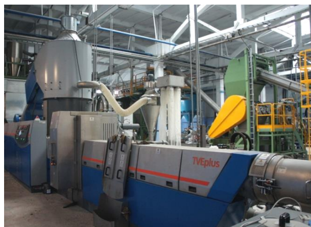
Линия для гранулирования отходов пластмасс /Фото: ОАО «Белваторполимер»
